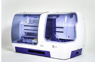
Le BDI I est un instrument qui réalise les différentes étapes d'incubation et de lavage des bandelettes microarray d'Alphadia, du dépôt de l'échantillon au développement final de la couleur. La capacité maximale est de 24 bandelettes qui sont incubées simultanément. Chaque bandelette est associée à une cartouche contenant les différents réactifs permettant de réaliser le test. Le BDI I dispose d'un lecteur de code-barres qui contrôle la bonne association entre une bandelette et sa cartouche.
